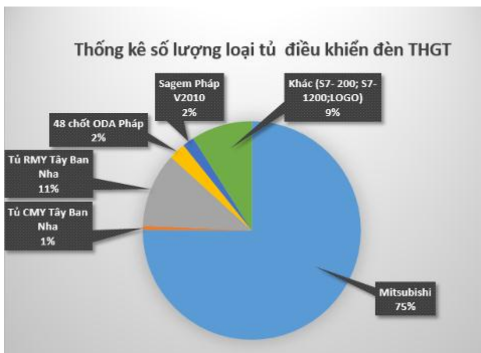
Hình 2.1. Thống kê các loại tủ điều khiển đèn THGT – sự không đồng bộ
